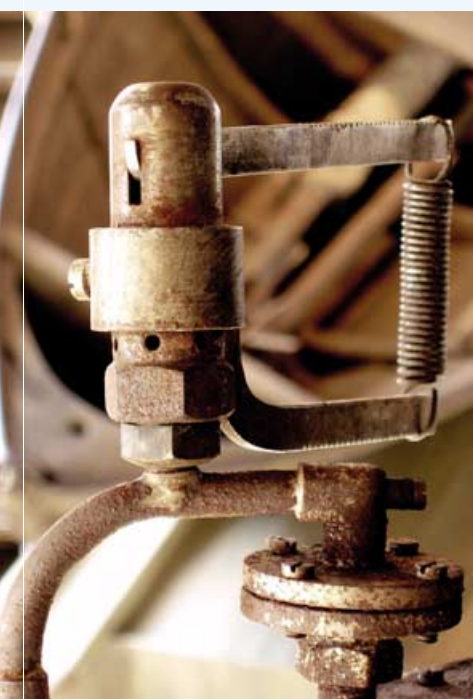
Bild 10: Das federbelastete Überdruckventil
