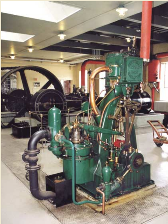
Bild 6: Rückansicht der Maschine aus Bild 5, Kühlwasserpumpe und Kondensator sind integriert.
