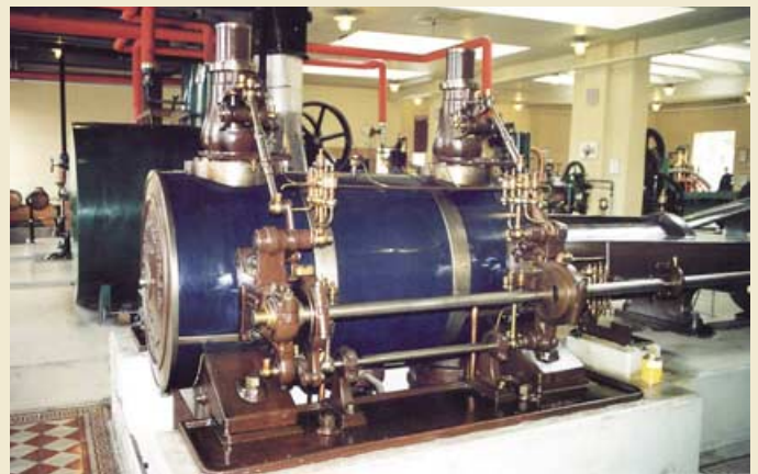
Bild 11: Blick auf die Ventilsteuerung am Niederdruckzylinder der Maschine aus Bild 10.
