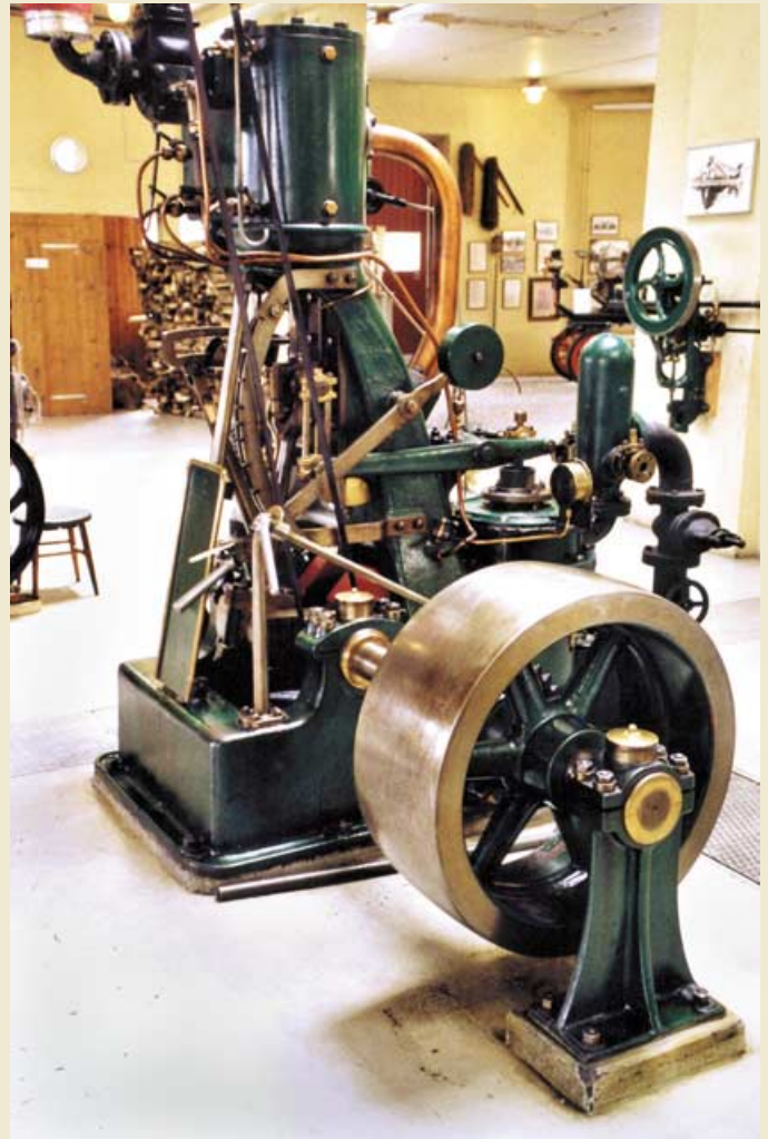
Bild 5: Einzylinder-Dampfmaschine aus dem Jahre 1902.
