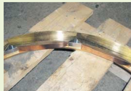
Bild 6: Kolbenringsegmente mit Bronzefedern
