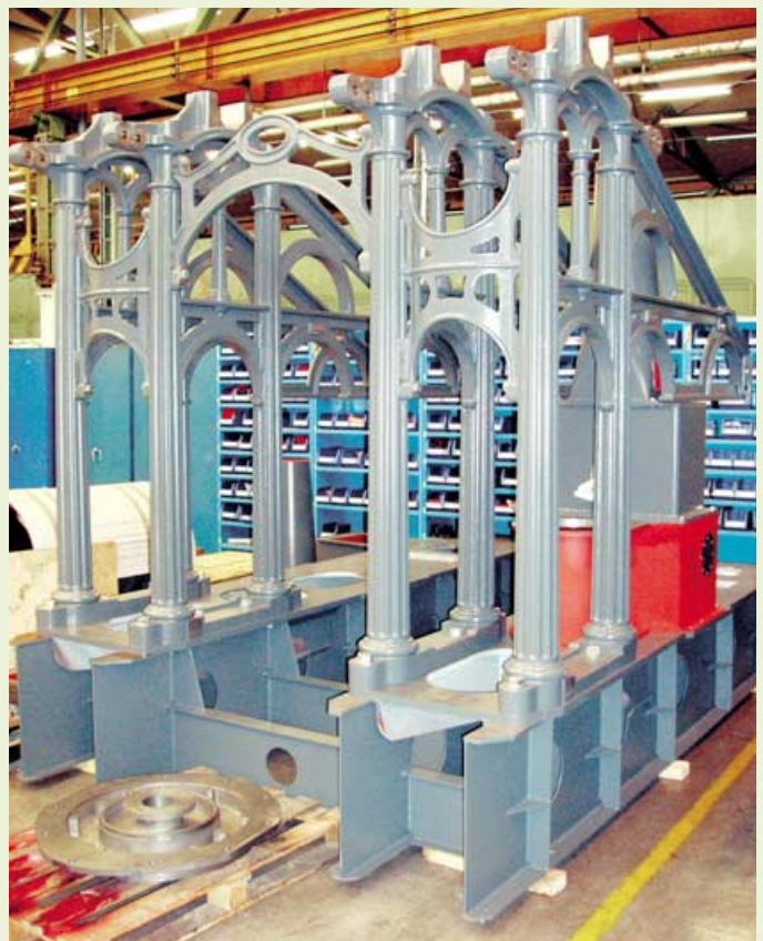
Bild 12: Maschinenständer mit Fundament
