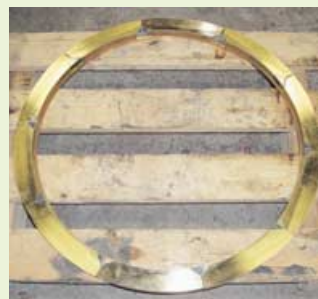
Bild 5: Kolbenring, bestehend aus 10 Segmenten
