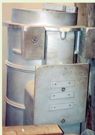
Bild 9: Gussmodell eines Zylinders
