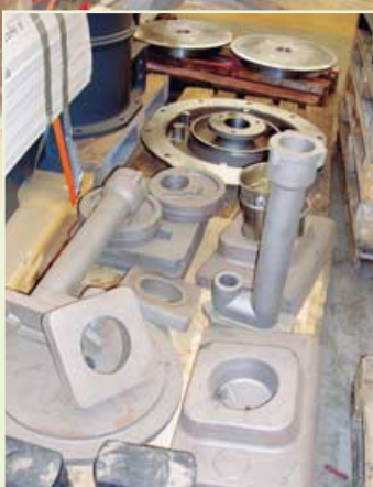
Bild 14: verschiedene Gussteile, im Hintergrund Kolben und Zylinderdeckel
